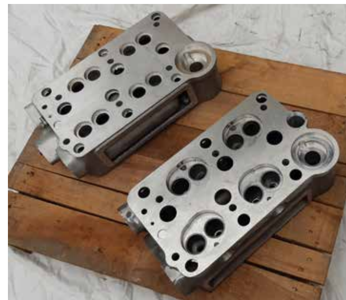
Photo 87: Culasses de Lancia Lambda (les premières séries à gauche, les séries ultérieures à droite)
