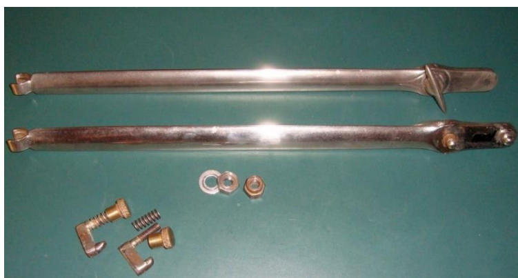
Le due colonne ancorate al parabrezza, i due dadi per fissare la capote alle colonne e due stabilizzatori per la capote.
