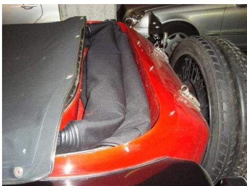
La capote nel suo gavone. La vite ed il dado (originariamente un dado a farfalla) destinato al fissaggio della capote al parabrezza.
