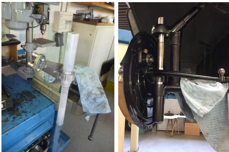
Fuselli sul fodero della sospensione anteriore. Durante il rimontaggio, con il braccetto dello sterzo.
