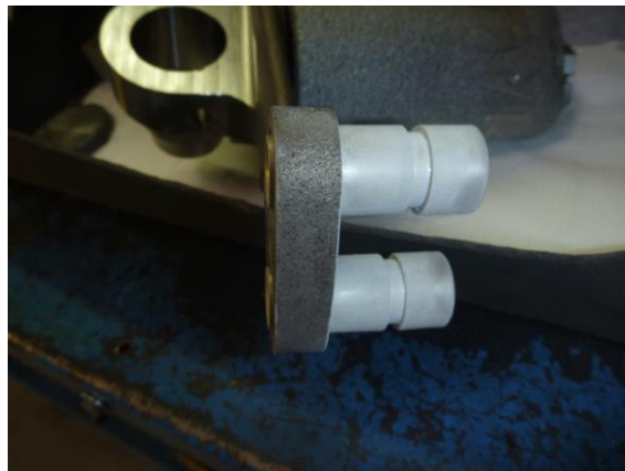
Inserimento dei perni supporto ganasce freno, molto freddi.
