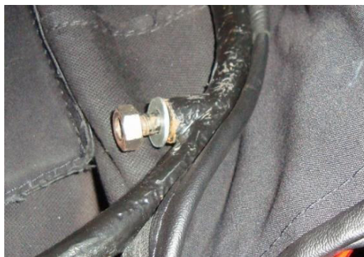
La capote nel suo gavone. La vite ed il dado (originariamente un dado a farfalla) destinato al fissaggio della capote al parabrezza.
