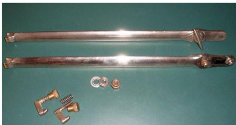
*Les deux colonnes fixées au parebrise, avec les deux écrous à ailettes pour fixer les colonnes au montant de parebrise, et les deux raidisseurs pour l'armature*
