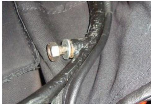
*Le goujon et l'écrou (à l'origine un écrou à ailettes) pour fixer la capote sur le parebrise.*
